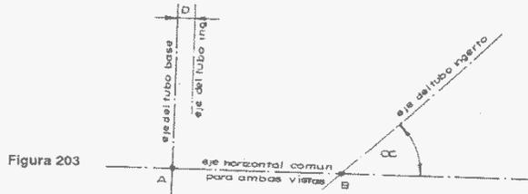
b. Después de trazar los ejes en los tubos, se describen al lado y lado de ellos sus contornos. El tubo injerto se traza con el diámetro interior y el tubo base con diámetro exterior.
